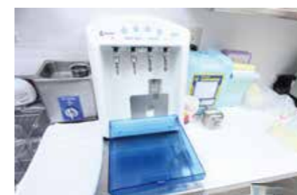
歯を削るタービンを滅菌する専用の装置です
